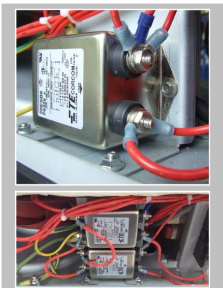
上 : EMCフィルター x1 (1000W e2s派生製品) 下 : EMCフィルター x2 (2000W e2s派生製品)
